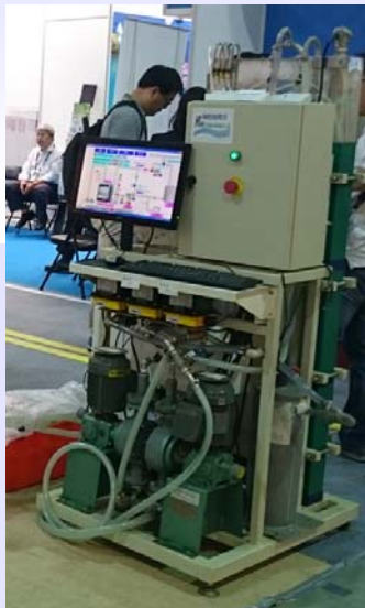
設備近端PLC自動控制及遠端連結監控
