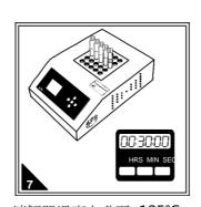
消解器溫度上升至 125℃ 後,依次放入標記好的空白 樣和待測樣,加熱消解 30 分 試管,放入試管架中置於通 鐘。
