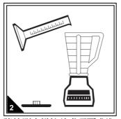
將待測水樣按前處理要求進 行混勻或過濾等操作。對於 懸浮物較多的水樣,應進行 攪拌等勻質化處理,以減小 取樣誤差。
