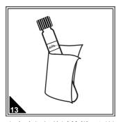
取出冷卻好的試管樣,用擦 鏡布或無毛屑的軟紙擦乾淨 試管外壁,放入水質檢測儀 内進行比色操作。
